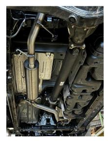
**3.** INSTALL MUFFLER **#B** ONTO HEAD PIPE 1-1/2" TO 2" WITH THE LOUVERS FACING TOWARDS THE CONVERTER. <u>THE</u> <u>MUFFLER OUTLET SHOULD</u> <u>BE POSITIONED AT 6:00,</u> THEN INSTALL OVERAXLE **#C** USING CLAMP **#F** ON BOTH ENDS OF THE MUFFLER. USE A JACK STAND TO SUPPORT THE MUFFLER. PIPE. DO NOT TIGHTEN.
