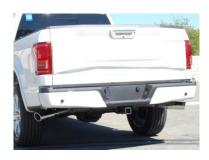
INSTALL YOUR BLACK TIPS TO YOUR DESIRED LOOK THEN GO BACK AND TIGHTEN ALL CLAMPS, ROTATE SYSTEM FOR BEST CLEARANCE BEFORE TIGHTENING.
