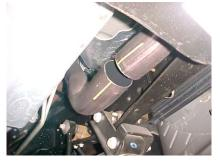
RE-INSTALL YOUR CATALYTIC CONVERTER TO THE NEW DOWN PIPE. USING YOUR FACTORY NUTS.
