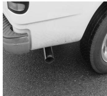
**MAKE SURE YOU HAVE AT LEAST 1" CLEARANCE ON ALL BRAKE & FUEL LINES, SHOCK, TIRES, ETC**
