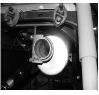
SLIDE MUFFLER #B ONTO
