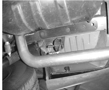
INSERT THE REAR TAILPIPE HANGER INTO THE FACTORY RUBBER GROMMET.
