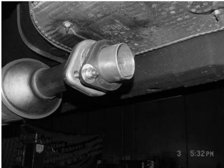
**2.) SLIDE THE 2-BOLT FLANGE ONTO THE SLIP JOINT PART #A. NOW INSTALL TO THE FACTORY FLANGE AND USE BOLT KIT #H TO ATTACH.**
