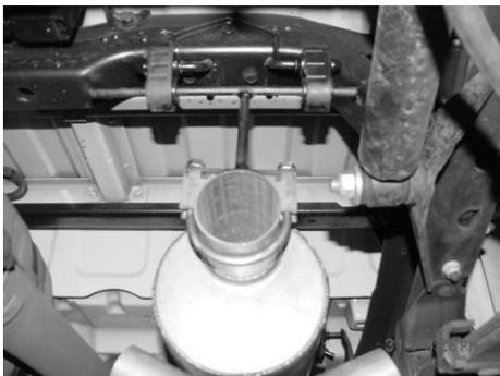
**3.) NEXT INSTALL MUFFLER PART #B WITH THE INLET TOWARDS THE MOTOR. (INLET IS THE OPEN LOUVERS IN THE MUFFLER FACING THE MOTOR.) ROTATE THE MUFFLER SO THE OUTLET IS AT AN 8 O'CLOCK POSITION. USE CLAMP #G TO SECURE THE MUFFLER TO THE HEADPIPE. DO NOT TIGHTEN. MAKE SURE MUFFLER IS PUSHED ALL THE WAY ON THE HEADPIPE TILL IT HITS THE FLANGE. USE A JACKSTAND TO SUPPORT THE MUFFLER.**
