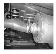
INSTALL MUFFLER #A ONTO FACTORY PIPE. USE CLAMP #ETO ATTACH THE MUFFLER TO THE FACTORY HEADPIPE. DO NOT TIGHTEN. THE MUFFLER OUTLET WILL BE POSITIONED AT ABOUT 7 OR 8 O'CLOCK. THE MUFFLER INLET WILL BE LOOKING INTO THE LOUVERS.
