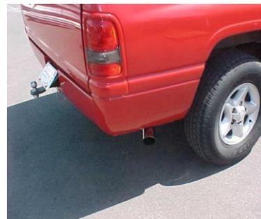
**MAKE SURE YOU HAVE A 1" CLEARANCE ON ALL RUBBER BRAKE& FUEL LINES, SHOCK BOOTS, TIRE, ETC...**
