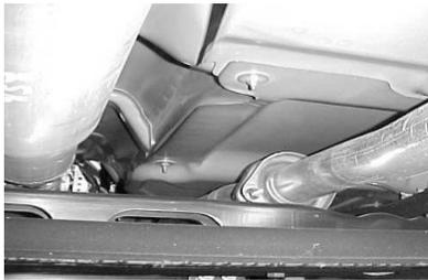
FOR EASIER REMOVAL OF THE FACTORY EXHAUST. CUT BEHIND THE MUFFLER AT THE TAILPIPE. THEN UNBOLT THE FACTORY HEADPIPE AT THE FLANGE IN FRONT OF THE MUFFLER **YOU WILL BE REUSING STOCK BOLTS.**
