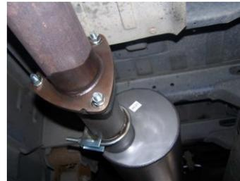
SLIDE MUFFLER ONTO THE FRONT HEADPIPE WITH THE INLET TOWARDS THE CONVERTER (MUFFLER INLET IS LOOKING INTO LOUVERS). USE THE JACK STAND TO SUPPORT THE MUFFLER AND CLAMP USING #G. DO NOT TIGHTEN. MUFFLER OUTLET SHOULD BE POSITIONED AT 9 O'CLOCK
