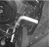
YOU MUST ROTATE THE FACTORY REAR TAILPIPE HANGER **BEFORE YOU** INSTALL THE OVER AXLE TAILPIPE.
