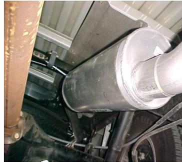
INSTALL THE MUFFLER ONTO THE HEADPIPE 1" TO 2". THE INLET OF THE MUFFLER WILL HAVE THE INSIDE LOUVERS FACING FORWARD. USE CLAMP #D TO SECURE MUFFLER TO THE HEADPIPE. OUTLET SHOULD BE AT THE 9 O'CLOCK POSITION. DO NOT TIGHTEN. MUFFLER INLET IS LOOKING INTO LOUVERS.
