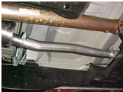
INSTALL THE HEADPIPE #A. USE CLAMP #F TO SECURE HEADPIPE TO FACTORY PIPE. DO NOT TIGHTEN. YOU WILL NOT USE THE FACTORY FRONT HANGER WITH THE GIBSON SYSTEM
