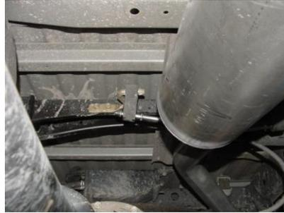
INSTALL THE MUFFLER ONTO THE HEADPIPE 1" TO 2". THE INLET OF THE MUFFLER WILL HAVE THE INSIDE LOUVERS FACING FORWARD. USE CLAMP #D TO SECURE MUFFLER TO THE HEADPIPE. OUTLET SHOULD BE AT THE 9 O'CLOCK POSISTION. DO NOT TIGHTEN. MUFFLER INLET IS LOOKING INTO LOUVERS.
