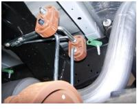
4. INSTALL OVERAXLE TAILPIPE # C INTO THE OUTLET OF THE MUFFLER 1½" TO 2". INSERT THE REAR WELDED HANGER INTO THE FACTORY RUBBER GROMMET. USE CLAMP #E TO ATTACH THE OVERAXLE PIPE TO THE MUFFLER OUTLET. DO NOT TIGHTEN.
