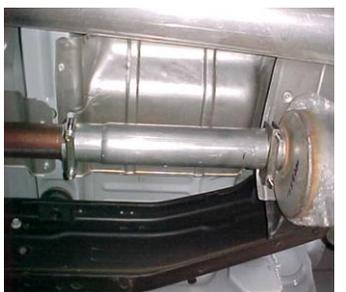
**MAKE SURE YOU HAVE AT LEAST 1" CLEARANCE ON ALL BRAKE & FUEL LINES, SHOCK, TIRES, ETC...**
