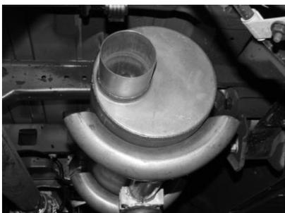
SLIDE MUFFLER # C ONTO HEADPIPE 1 1/2" TO 2". THE INLET IS FACING THE MOTOR. MUFFLER INLET IS LOOKING INTO THE LOUVERS. THE MUFFLER OUTLET SHOULD BE AT THE 9 O'CLOCK POSITION.
