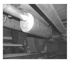
NEXT, CONNECT THE MUFFLER # B TO THE HEADPIPE USING CLAMP # F. USE JACKSTAND TO SUPPORT THE MUFFLER. THE OUTLET OF THE MUFFLER WILL BE AT APPROXIMATELY 9 O'CLOCK. THE MUFFLER INLET IS LOOKING INTO THE LOUVERS.
