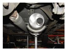
INSTALL MUFFLER #B ONTO HEADPIPE WITH INLET TOWARDS THE MOTOR. INLET OF MUFFLER IS LOOKING INTO THE LOUVERS. THE MUFFLER OUTLET SHOULD BE AT THE 4 O'CLOCK POSITION. USE CLAMP #F TO SECURE THE MUFFLER TO THE HEADPIPE. MUFFLER INLET IS LOOKING AT THE LOUVERS. DO NOT TIGHTEN.
