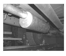
NEXT CONNECT THE MUFFLER TO THE HEADPIPE USING CLAMP # F. USE JACKSTAND TO SUPPORT THE MUFFLER. THE OUTLET OF THE MUFFLER WILL BE AT APPROXIMATELY 10 O'CLOCK. THE MUFFLER INLET IS LOOKING INTO THE LOUVERS.
