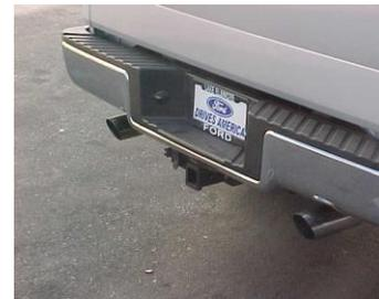
MAKE SURE YOU AT LEAST A 1" CLEARANCE ON ALL BRAKE LINES, FUEL LI SHOCKS, TIRES, ETC. USE ZIP TIES TO TIE THE BRAKE LINES OUT OF THE
