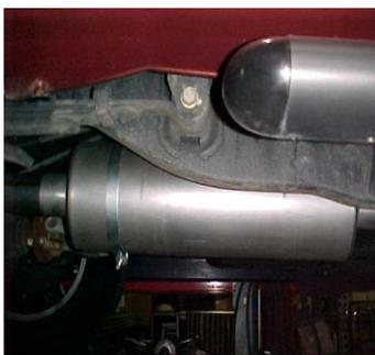
INSTALL MUFFLER # C ONTO YOUR RESONATOR 1 1/2"-2". USE CLAMP # G TO SECURE MUFFLER TO THE PIPE, DO NOT TIGHTEN.
