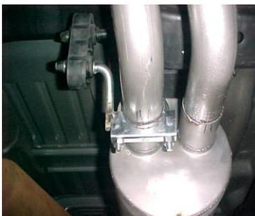
INSTALL REAR MUFFLER HANGER # I ONTO DRIVER SIDE OUTLET OF THE MUFFLER AND INSERT THE WELDED HANGER INTO RUBBER GROMMET.
