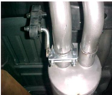
INSTALL REAR MUFFLER HANGER # I ONTO DRIVER SIDE OF THE MUFFLER AND INSERT THE WELDED HANGER INTO RUBBER GROMMET.
