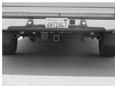
**MAKE SURE YOU HAVE A MINIMUM OF A 1" CLEARANCE FROM ALL PIPES FROM BRAKE & FUEL LINES, TIRES, SHOCKS, ETC...**
