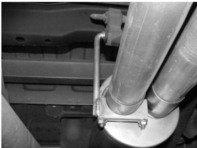
INSTALL REAR MUFFLER HANGER #I ONTO DRIVERSIDE MUFFLER OUTLET. INSERT THE WELDED HANGER INTO RUBBER GROMMET. DO NOT TIGHTEN.
