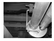
INSTALL REAR MUFFLER HANGER #I ONTO DRIVERS SIDE MUFFLER OUTLET. INSERT THE WELDED HANGER INTO RUBBER GROMMET. DO NOT TIGHTEN.
