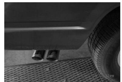
**MAKE SURE YOU HAVE A 1" CLEARANCE ON ALL PIPES FROM ALL FUEL, BRAKE LINES, SHOCK BOOTS, TIRES, ETC.**
