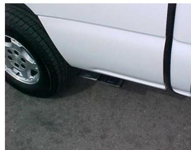
**MAKE SURE YOU HAVE AT LEAST A 1" CLEARANCE ON ALL PIPES FROM ALL RUBBER BRAKE LINES, FUEL LINES, SHOCK BOOTS, TIRES, ETC.**
