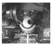
SLIDE MUFFLER #B ONTO HEADPIPE 1 1/2" TO 2". USE CLAMP #E TO SECURE MUFFLER TO HEADPIPE. DO NOT TIGHTEN. OUTLET SHOULD BE AT THE 3 O'CLOCK POSITION. MUFFLER INLET IS LOOKING INTO THE LOUVERS.
