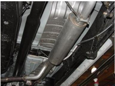
INSTALL MUFFLER #B ONTO HEADPIPE ASSEMBLY AT LEAST 1-1/2" TO 2". USE A JACK STAND TO SUPPORT THE MUFFLER. THE OUTLET OF THE MUFFLER SHOULD BE AT THE 6 O'CLOCK POSITION.
