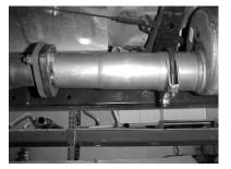
USING FACTORY NUTS, BOLTS, AND GASKET INSTALL HEADPIPE #A TO EXISTING FLANGE. THE WELDED 02 SENSOR FLANGE WILL BE POSITIONED ON THE PASSENGER SIDE OF THE HEADPIPE. RE-USING FACTORY GASKET. RE-INSTALL THE 02 SENSOR. DO NOT USE GASKET SEALER.
