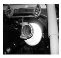
SLIDE MUFFLER #B ONTO HEADPIPE #A 1-1/2"-2". THE MUFFLER INLET WILL HAVE THE INSIDE LOUVERS FACING FORWARD TOWARDS THE ENGINE AND THE REAR OUTLET OF THE MUFFLER WILL BE AT 10:00 O'CLOCK POSITION.
