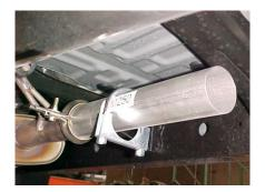
INSTALL THE GIBSON HEADPIPE #A. MAKE SURE THE HEADPIPE IS STRAIGHT. YOU MAY WANT TO GENTLY TAP THE END OF THE HEADPIPE TO ENSURE A TIGHT FIT. CLAMP DOWN THE FACTORY CLAMP AT THE FRONT OF THE HEADPIPE. **DO NOT TIGHTEN.**
