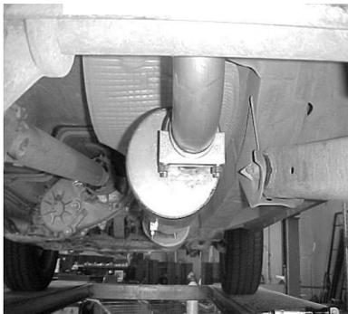
INSTALL THE MUFFLER TO HEADPIPE AND USE CLAMP #E TO ATTACH. PUSH MUFFLER TILL IT HITS THE ALIGNMENT PIN. YOU WILL NEED TO ROTATE THE MUFFLER TO A 2 O'CLOCK POSITION. MUFFLER INLET IS LOOKING INTO THE LOUVERS.
