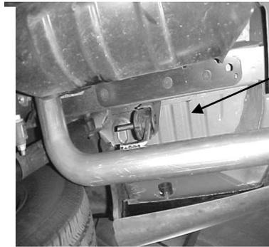
INSERT THE REAR TAILPIPE HANGER INTO THE FACTORY RUBBER GROMMET.
