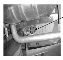
INSERT THE REAR TAILPIPE HANGER INTO THE FACTORY RUBBER GROMMET.
