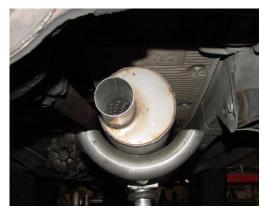
INSTALL MUFFLER #A ONTO STOCK HEADPIPE. OUTLET SHOULD BE AT THE 9 O'CLOCK POSITION. USE A JACK STAND TO SUPPORT THE MUFFLER. YOU WILL USE CLAMP #D TO SECURE THE MUFFLER TO THE STOCK PIPE. DO NOT TIGHTEN. MUFFLER INLET IS LOOKING INTO THE LOUVERS.
