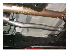
INSTALL THE HEADPIPE #A. USE CLAMP #F TO SECURE HEADPIPE TO FACTORY PIPE. DO NOT TIGHTEN. YOU WILL NOT USE THE FACTORY FRONT HANGER WITH THE GIBSON SYSTEM.
