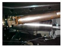
INSTALL THE MUFFLER ONTO THE HEADPIPE 1" TO 2". THE INLET OF THE MUFFLER WILL HAVE THE INSIDE LOUVERS FACING FORWARD. USE CLAMP #E TO SECURE MUFFLER TO THE HEADPIPE. OUTLET SHOULD BE AT THE 7 O'CLOCK POSISTION. DO NOT TIGHTEN
