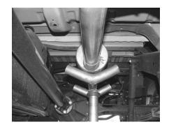
INSTALL THE MUFFLER ONTO THE HEADPIPE 1" TO 2". THE INLET OF THE MUFFLER WILL HAVE THE INSIDE LOUVERS FACING FORWARD. OUTLET WILL BE AT THE 12 O'CLOCK POSITION. DO NOT TIGHTEN. MUFFLER INLET IS LOOKING INTO LOUVERS.
