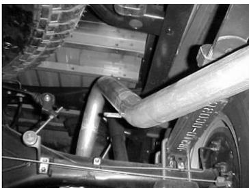
SLIP PASSENGER SIDE OVER AXLE TAILPIPE #C OVER THE OUTLET OF THE MUFFLER 1 1/2 TO 2". INSERT THE WELDED HANGER INTO THE FACTORY RUBBER GROMMET, AND ATTACH TO MUFFLER
