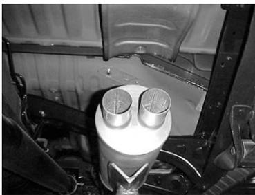
SLIP THE MUFFLER #B ONTO THE HEAD PIPE 1 1/2 TO 2". USE CLAMP #F TO ATTACH THE MUFFLER TO THE HEADPIPE. DO NOT TIGHTEN. MAKE SURE THE MUFFLER OUTLETS ARE LEVEL. USE A JACK STAND TO SUPPORT THE
