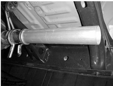
INSTALL HEADPIPE #A ONTO THE FACTORY EXTENSION PIPE. MAKE SURE THAT THE HEADPIPE IS STRAIGHT, NOT ANGLED UP OR DOWN. YOU MAY WANT TO LIGHTLY TAP ON THE END OF THE PIPE TO
