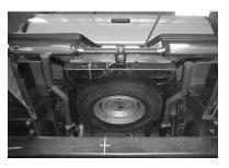
MAKE SURE YOU HAVE A 1" CLEARANCE AWAY FROM ALL BRAKE LINES, FUEL LINES, SHOCKS, TIRES, ETC.
