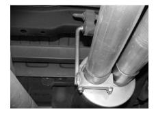
INSTALL REAR MUFFLER HANGER #I ONTO DRIVERS SIDE MUFFLER OUTLET. INSERT THE WELDED HANGER INTO RUBBER GROMMET. DO NOT TIGHTEN.
