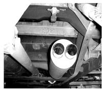
INSTALL MUFFLER #B ON TO THE HEADPIPE
