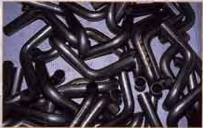
マンドレルベントでパイプが自在に曲げられていく。ストレートのパイプがいろんな形を持ったパーツへと進化する。
