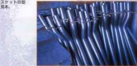
マンドレルベントでパイプが自在に曲げられていく。ストレートのパイプがいろんな形を持ったパーツへと進化する。
