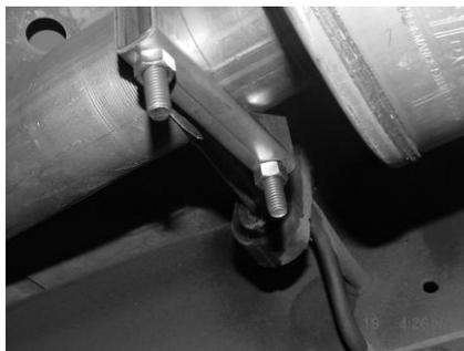
ADJUST MUFFLER ASSEMBLY FOR TAILPIPE EXITS.
